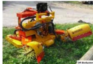
Minicingolato con trincia laterale rientrante, trincia doppio rientrante e trincia centrale con flagelli laterali rientranti.
