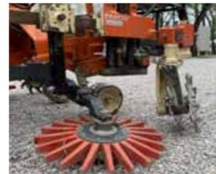
Alternative già presenti nei comprensori viticoli: disco motrice, la lama ed il vomere tutti doppi e dotati di tastatori per il rientro automatico e ancora il Rollhacke e il Fingerhacke sempre per la lavorazione meccanica sottochioma.
